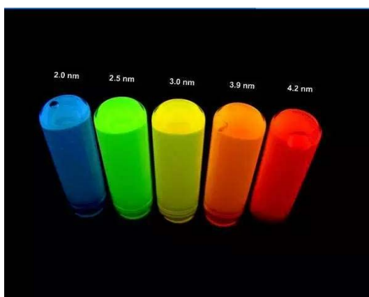
图 10.12 不同尺寸大小与结构的量子点经能量诱发后发出不同的颜色
