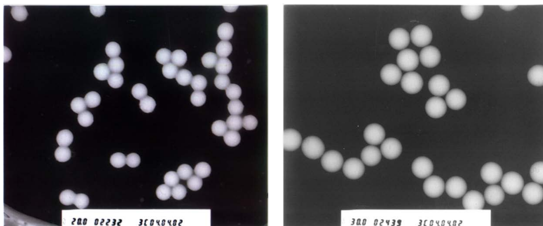
图 4-3 SiO 2 胶体颗粒超声分散前（左图）后（右图）的分散状态
