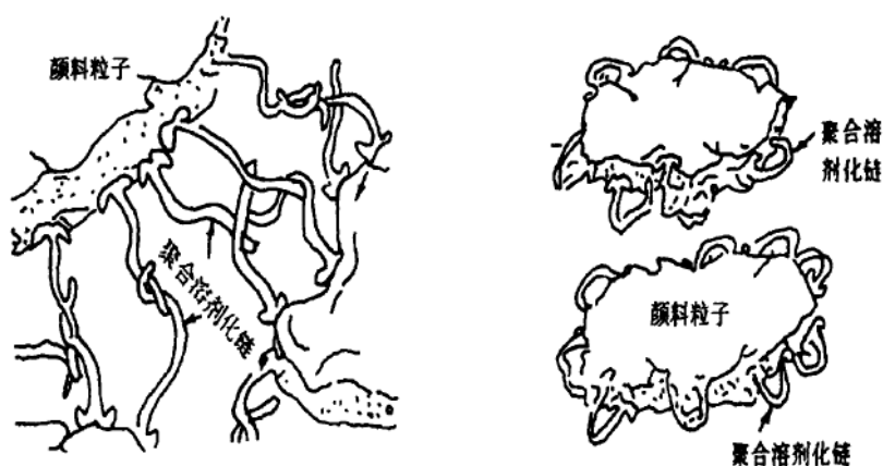
图 4-23 超分散剂的缠结（左图），超分散剂的折叠（右图）
