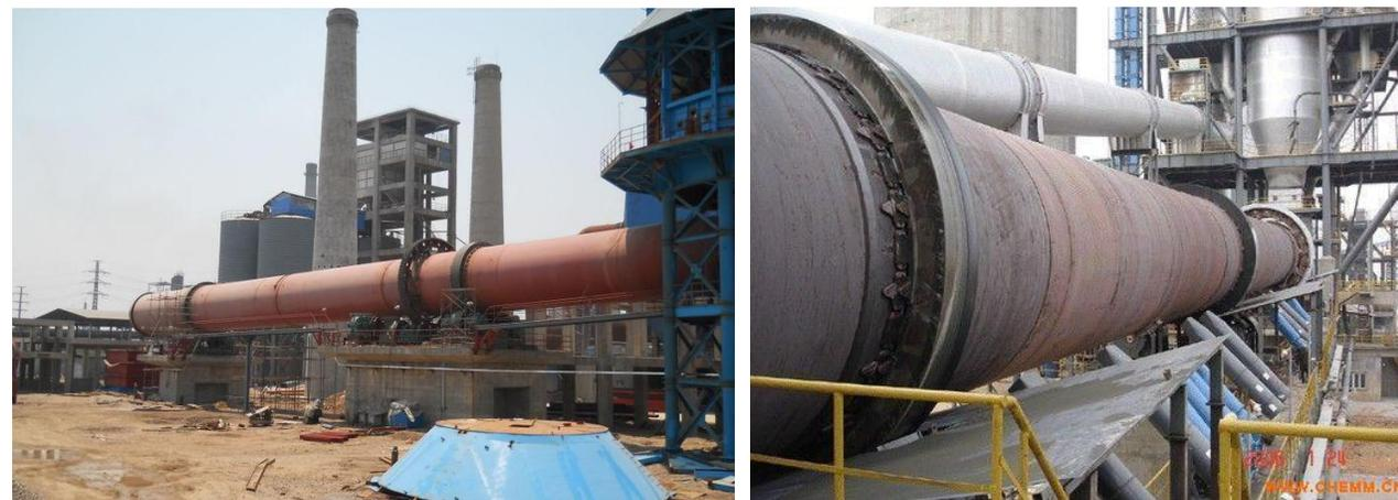
回转窑烟化处理锌浸出渣的实质是一个碳热还原挥发的过程，即在高温条件下，通过碳热还原，先将金属化合物还原成金属，然后通过炉气将其氧化成氧化物，以烟尘形式进行收集。
