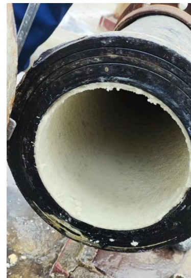
硫酸镁结晶导致管道堵塞
