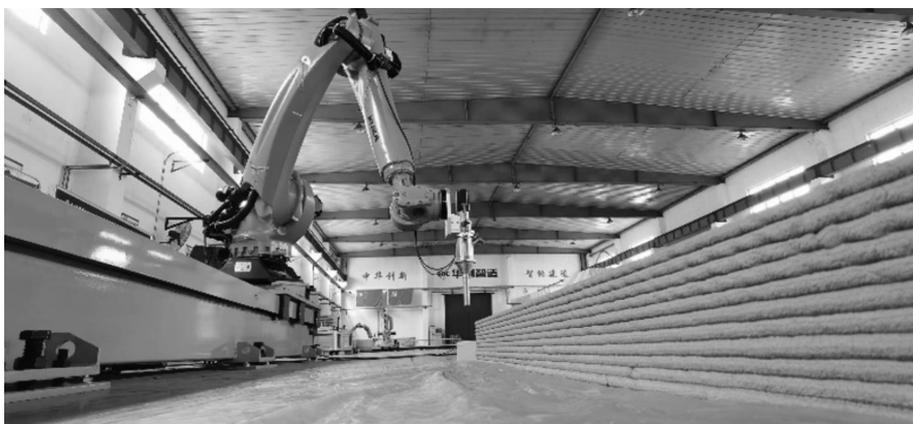
图 1 混凝土 3D 打印机器人
