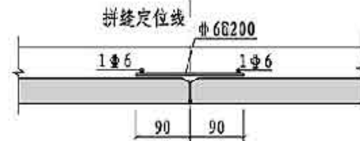
单向板拼缝构造大样
