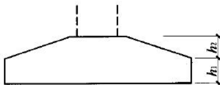
图 5-38 坡形截面普通独立基础竖向尺寸
