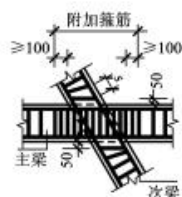
主次梁斜交箍筋构造
